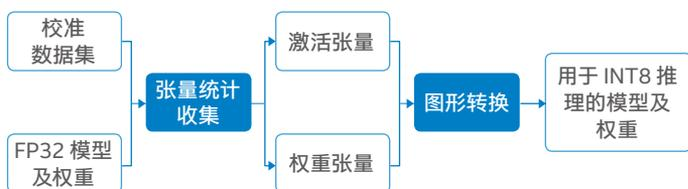
图一 飞桨离线 INT8 推理校准流程
